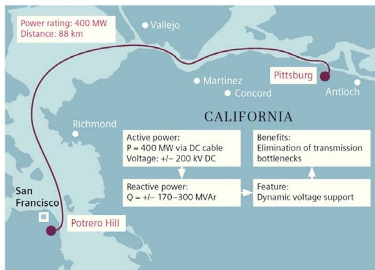
**Bild 2.56** Erste von Siemens realisierte HGÜ-Verbindung auf der Basis der Modularen Multi-Level-Stromrichter: Trans Bay Cable
